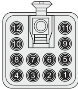
Fig. 6-11: Schéma des pôles, vue du côté du connecteur
